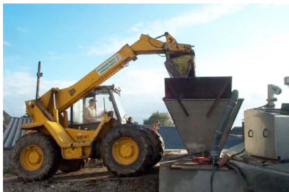
Introduction de substrat solide par trémie. Photo SOLAGRO
