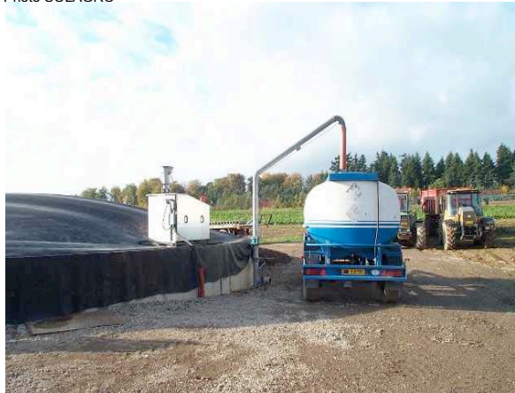
Extraction du digestat par pompage et tonne à lisier. Photo SOLAGRO
