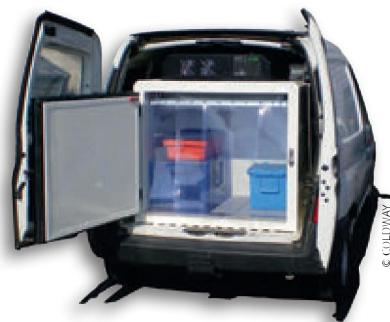
16 Le système de réfrigération thermo-chimique de la société Coldway, fondée par des chercheurs du CNRS, permet de conserver les produits sensibles.
