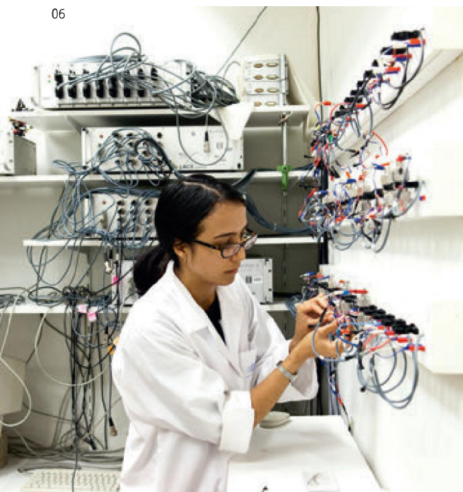
06 Banc de test des matériaux de stockage électrochimique au Laboratoire de réactivité et chimie des solides (LRCS), à Amiens.
