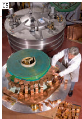
05 Bobine supraconductrice qui permet de stocker l'énergie sous forme d'un champ magnétique.
