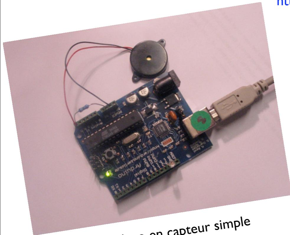
Montage du piezo en capteur simple
