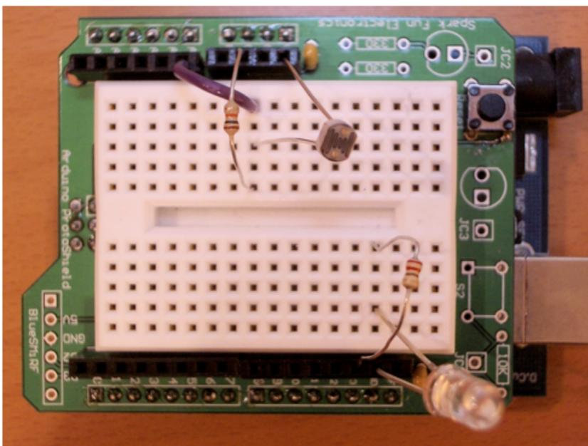
Le montage, ici réalisé sur une plaque d'expérimentation spécifique que l'on peut fixer sur l'Arduino
