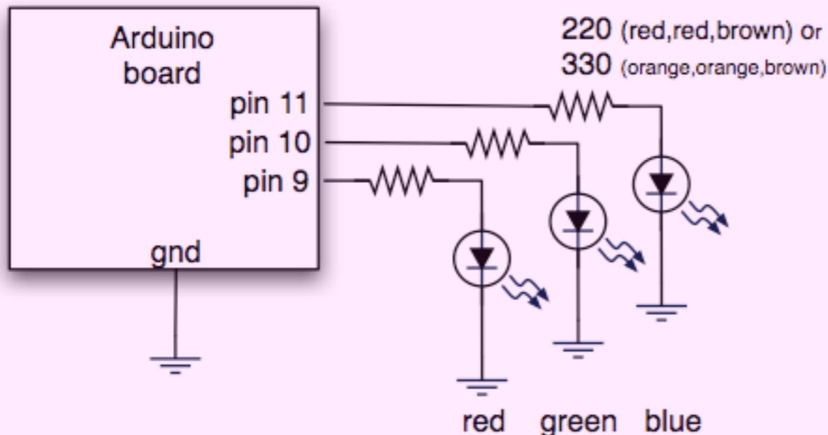
Piloter un éclairage à Leds RVB en milliers de couleurs, avec les sorties PWM
