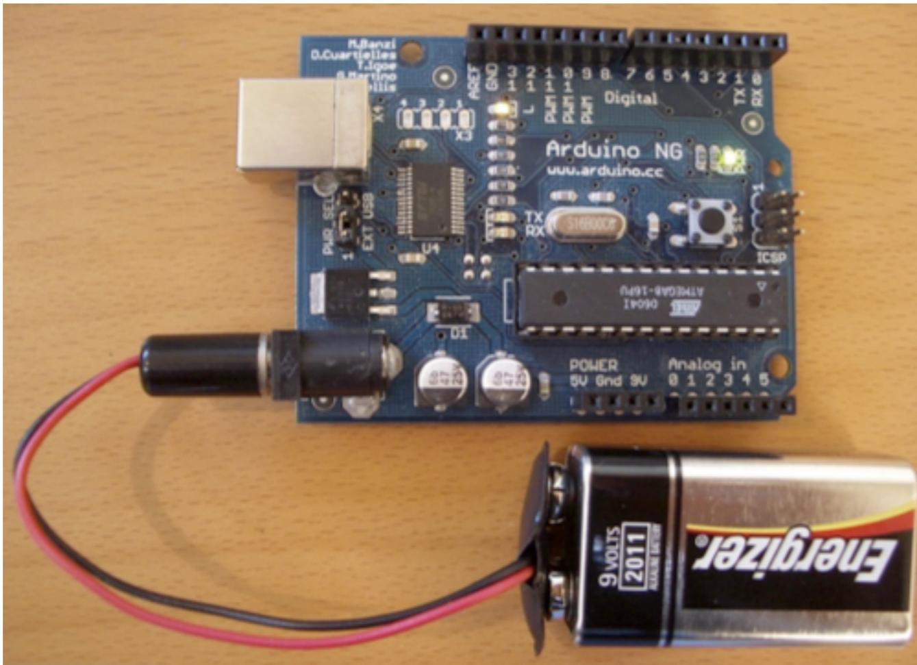
Avec une pile 9V et un connecteur
